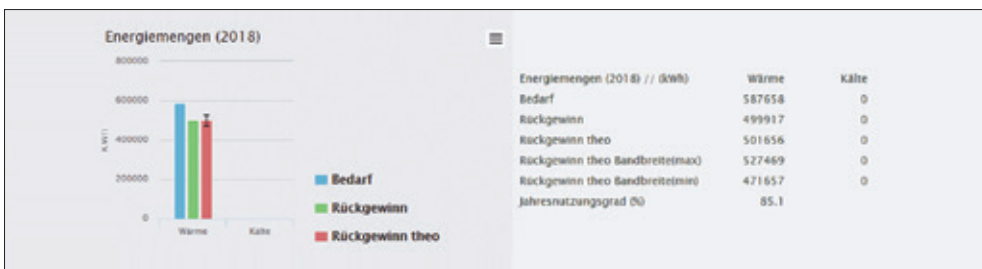
Energiedaten ausgewiesen auf dem WRG-Controller. Gesamtbedarf, Rückgewinn durch das System und die theoretischen möglichen Leistungen. Jahresnutzungsgrad Wärme für den Januar und Februar 2018 – über 85%!
